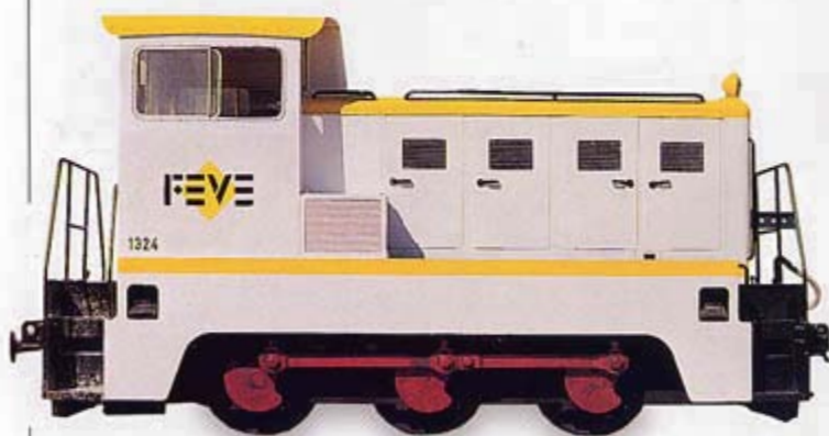
51. Maniobretako diesel lokomotora
